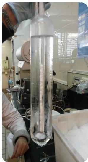
Preparación de la celda del punto triple de agua
