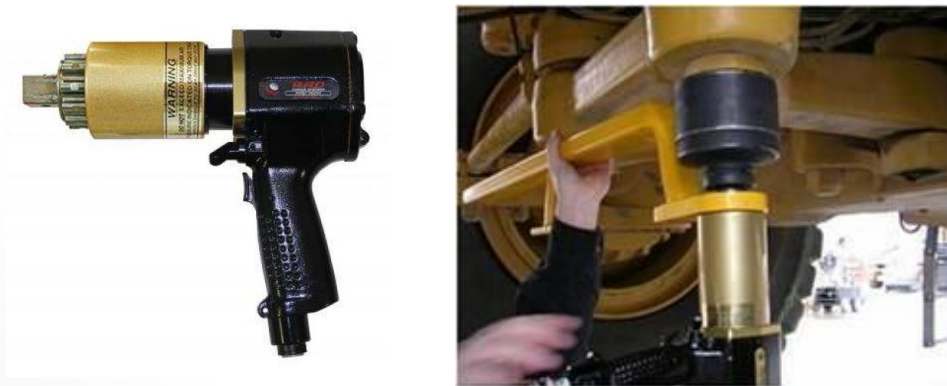
Fig.2. Herramienta utilizada para ajustar el torque de piezas sensitivas de equipos industriales.
